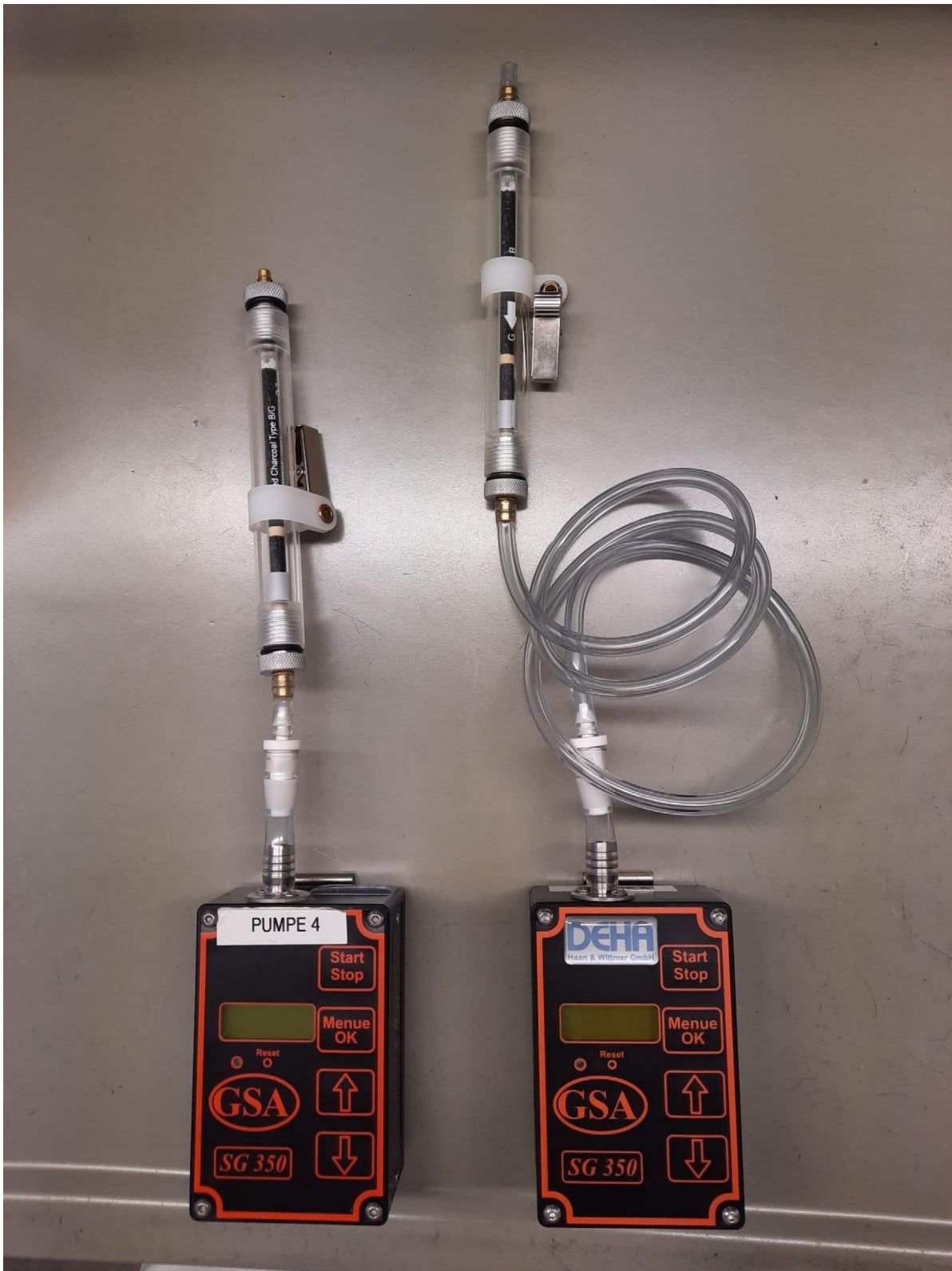
Abb. 1 Aufbau der Probenträger, links für stationäre Messungen, rechts für personengetragene Messungen, zusammengesetzt aus Sammelröhrchen (Typ B/G) im Röhrchenhalter, Verbindungsschlauch und Probenahmepumpe (SG350ex)
